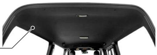
② 付属の型紙を用意し、天井トリムに穴を開ける準備をします。型紙を純正ピン位置にあわせ、穴あけ位置の中心に印をします。
